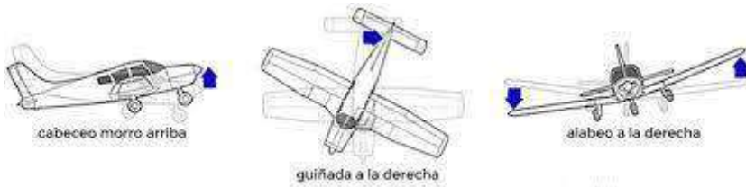
Figura 2.26. Movimientos de la aeronave
