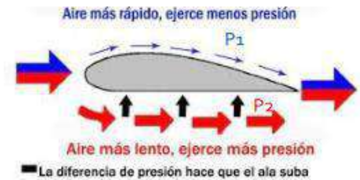
Figura 2.23. Teorema de Bernoulli aplicado en el ala de una aeronave. Vista de perfil
