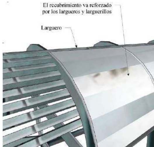
Figura 2.30. Fuselaje semimonocasco
